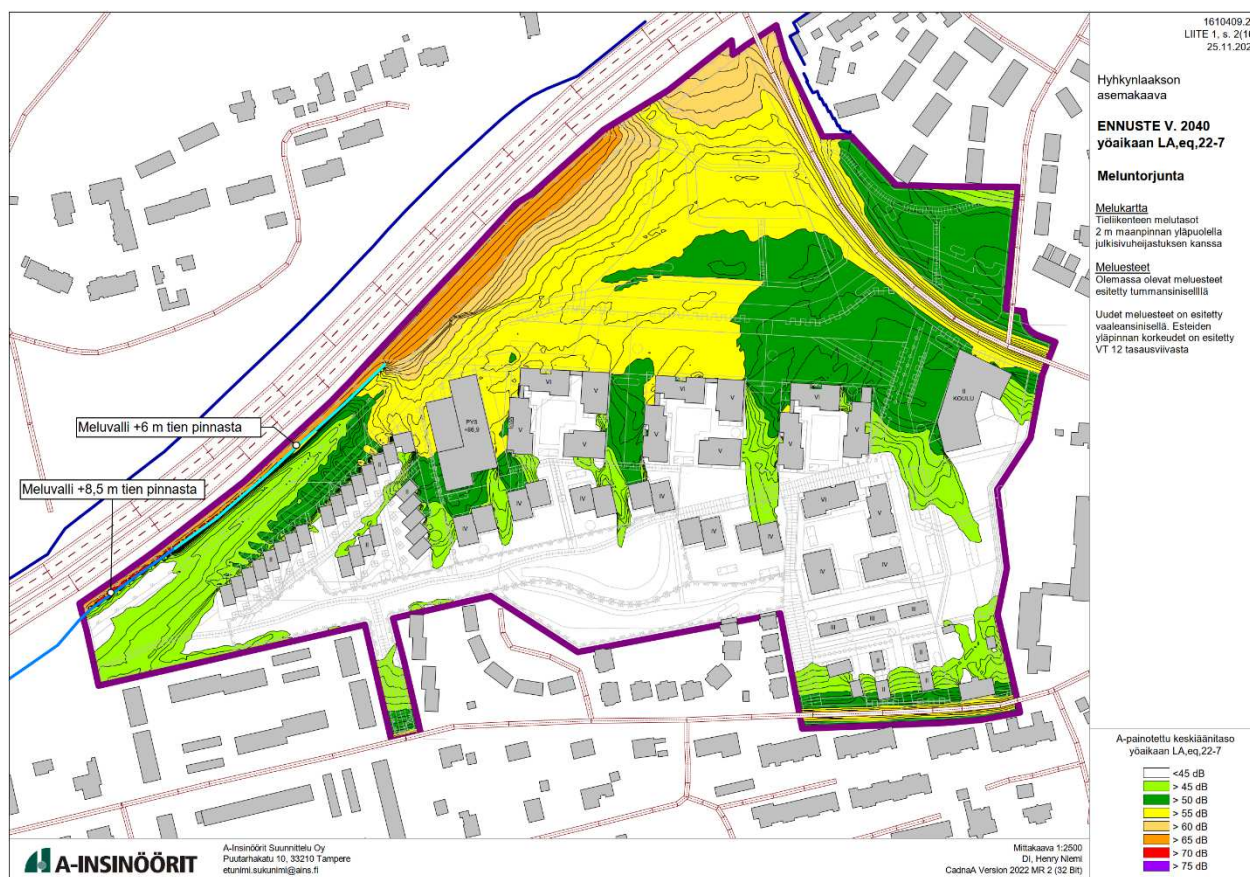
Kuva 17: Tarkistetun kaavaehdotuksen A-painotettu yöajan keskiäänitasoennuste 2040.
